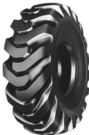
Especialmente desenvolvido para Motoniveladoras. Escultura da banda de rodagem direcional formada com os blocos em sentidos opostos proporcionam excelente tração e flutuação sobre superfícies moles (terreno com lama / barro) e função auto limpeza do sulcos.
